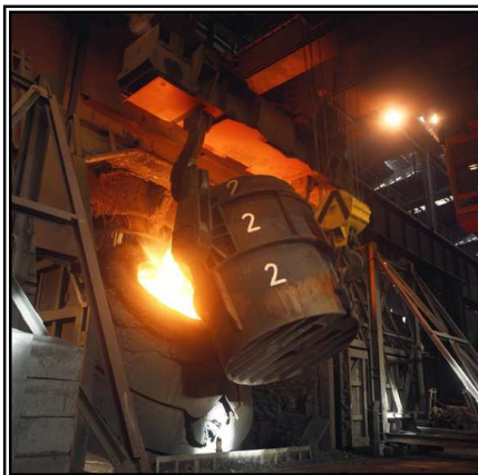
Carga de arrabio en el convertidor
