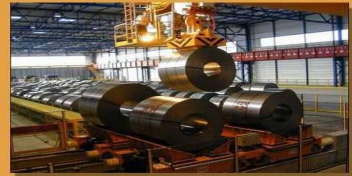
2.- Grúas mando por radiocontrol: No dar la espalda a la carga, no abandonar la carga suspendida, con cargas peligrosas no mover la carga y desplazarse al mismo tiempo.
