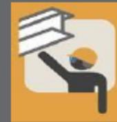
Mantenerse alejados de la carga y de los accesorios de elevación (nunca debajo de una carga suspendida, ni entre ésta y una estructura fija).
