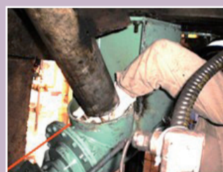
Simulación del accidente: la mano de la víctima quedó atrapada en el transportador sinfín.
