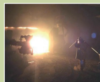
Toma de muestras y medición de temperatura en un horno eléctrico.
