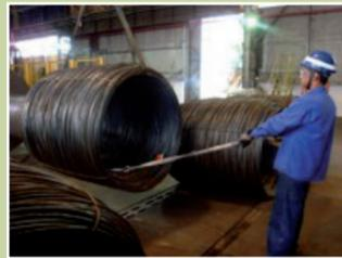
Actualmente: un operador utiliza un útil a modo de alargador para guiar la carga suspendida.
