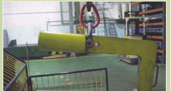
Gancho especial, con contrapeso, para el manejo de cargas en condiciones seguras.
