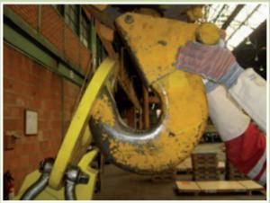
En Gueugnon se utiliza un balancín con una argolla inclinada para facilitar las tareas de enganche o desenganche y evitar un contacto peligroso.
