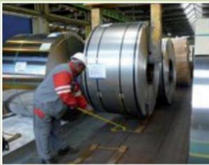
Actualmente: un operador utiliza una herramienta para posicionar la cuna bajo la bobina.
