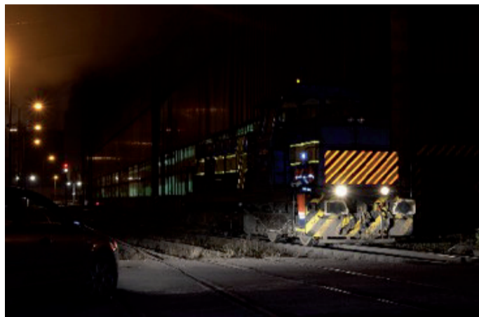
Vehículo ferroviario en ArcelorMittal Ostrava (República Checa), equipado con faros y paneles reflectantes.
