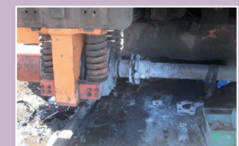
El operador que manejaba esta máquina sufrió quemaduras de segundo y tercer grado, tras conectarla por error a una tubería de oxígeno.
