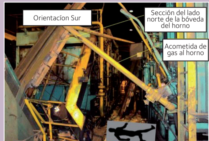
Lugar en el que fue encontrada la víctima. Se observa el efecto de la devastadora explosión de gas.
