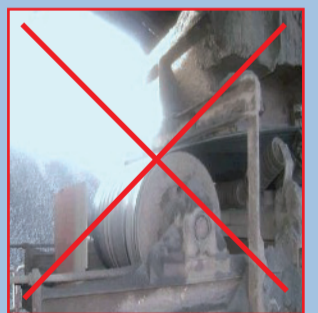
Ausencia total de protección.
