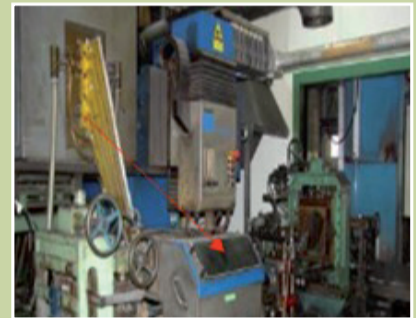
Cerramiento instalado para evitar la exposición del operador en el proceso de soldadura por láser (Montevideo, Uruguay).
