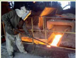
La valla de la fotografía actúa como barrera física para proteger a los operadores del riesgo de contacto con arrabio líquido.
