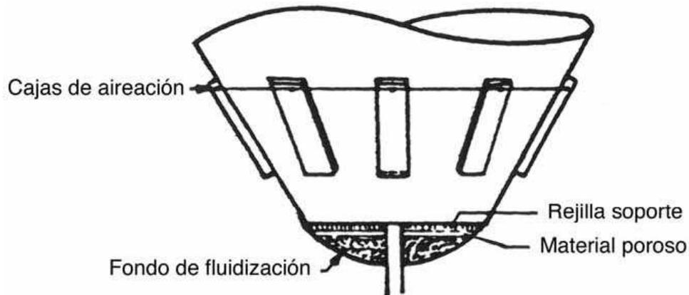
La parte inferior del silo va preparada para hacer la descarga del producto fluidificado al dosificador. El sistema de fluidificación consiste en seis cajas de aireación, que introducen aire comprimido seco en la parte cónica del silo, para producir un esponjamiento del material ensilado. Estas cajas son alimentadas desde una tubería anular que rodea el silo.
