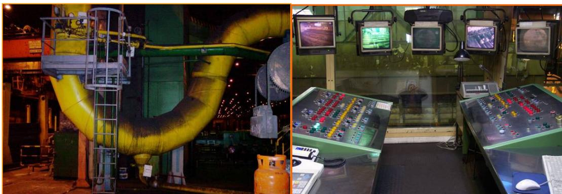
La capacidad del horno por diseño es de 150 t/h, siendo el avance de las piezas en su interior a través de vigas galopantes. Las dimensiones del horno son de 34 por 9 metros. El horno está dividido en cuatro secciones que, se etiquetan como CONVECCION ó TUNEL; PRECALENTAMIENTO, CALENTAMIENTO e IGUALACIÓN, respectivamente.
